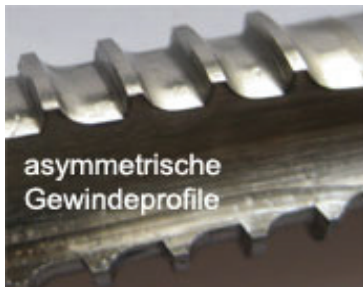
Gewindebohrer mit asymmetrischen Profilen. CAD / CAM.
